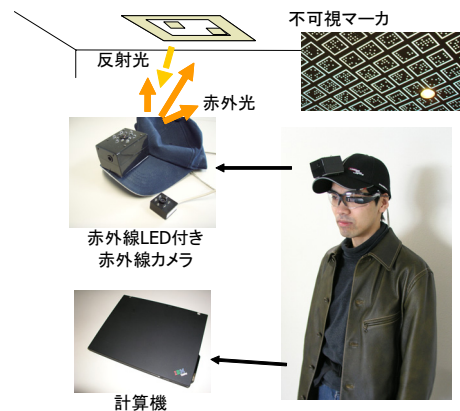
図2 不可視マーカを用いた位置・姿勢推定システム
