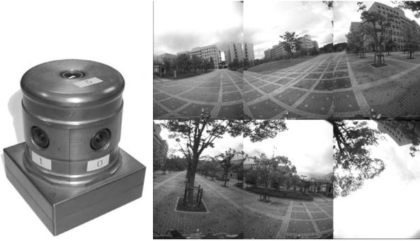
図6 データベースの構築に用いた全方位型マルチカメラシステム Ladybug と入力画像の一部
