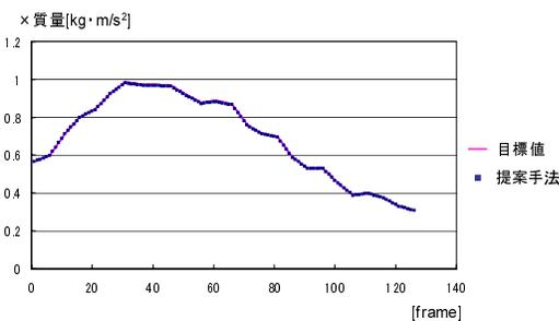
図9 進行方向に対して垂直横方向に対する慣性力の再現結果（左旋回時）
