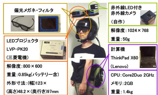
図 2: 提案システムの機器構成
