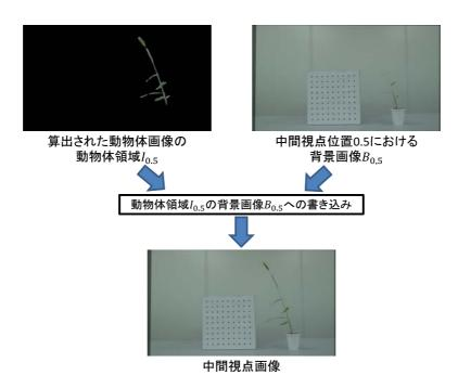
図 13 中間視点画像生成処理の流れ  $(q_i = 0.5)$
