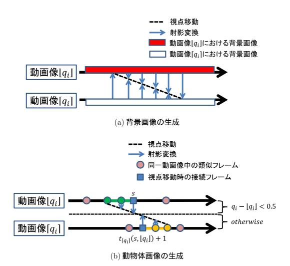
図 12 中間視点画像の生成 (隣接地点間を等速に視点移動した場合)
