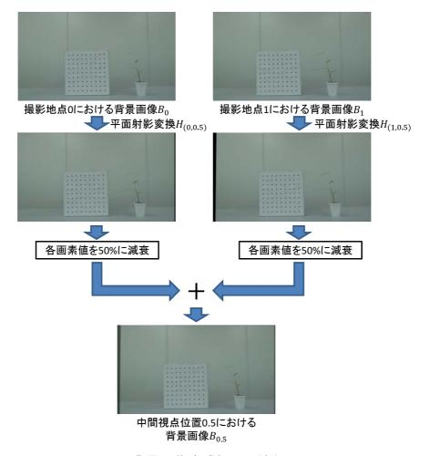
図 11 背景画像生成処理の流れ  $(q_i=0.5)$
