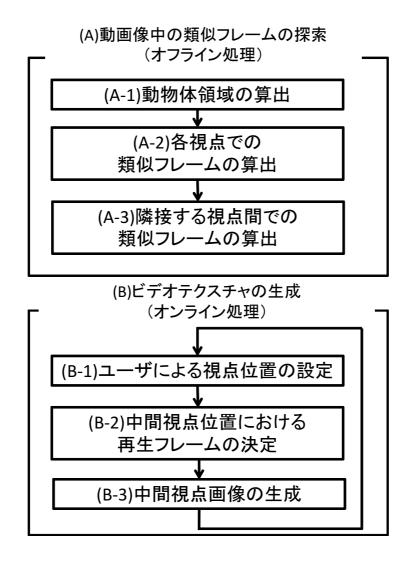
図 8 視点移動可能なビデオテクスチャ生成処理の流れ
