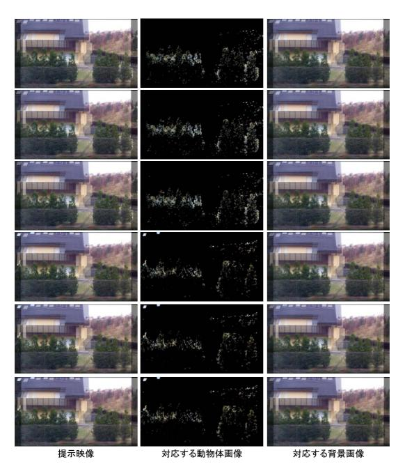
図 29 地点 (c) の前後のフレームの提示映像と対応する動物体画像と背景画像 (上から順に 176,177,178,179,180,181 フレーム目)
