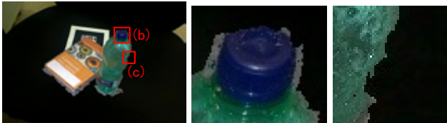
(a) 合成結果 (b) 輪郭の膨張領域 (c) 輪郭の欠損領域
