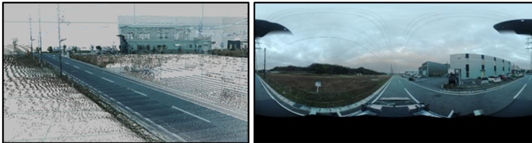
図 11 IP-S2 を用いて取得した三次元点群 (左) と全方位画像 (右)
