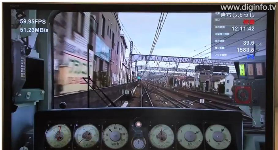
図 1 実写映像をもとにした列車用運転シミュレータ [4]
