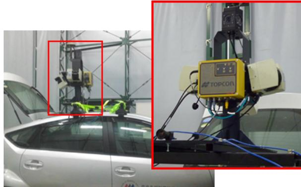
図 10 IP-S2 を搭載した実験車両
