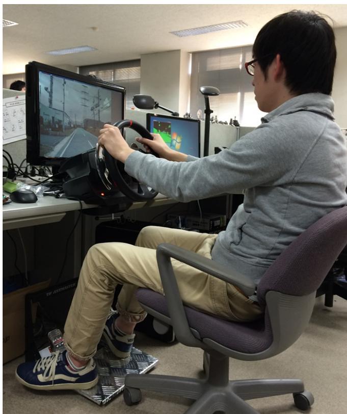
図 25 試作したドライブシミュレータシステムの外観
