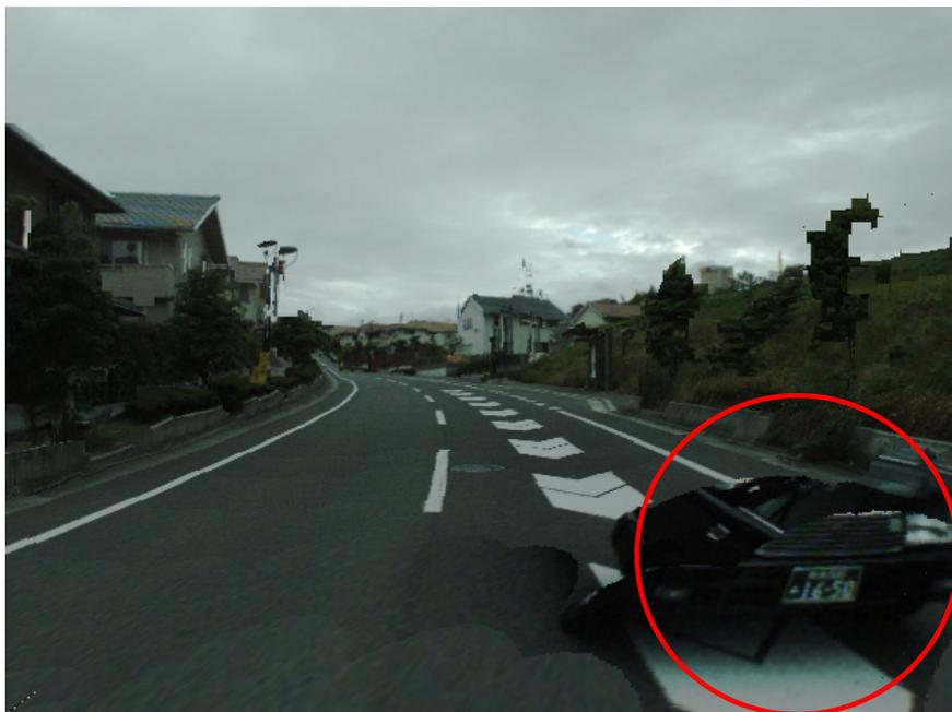
図 33 動物体の映り込みによる画像の歪み
