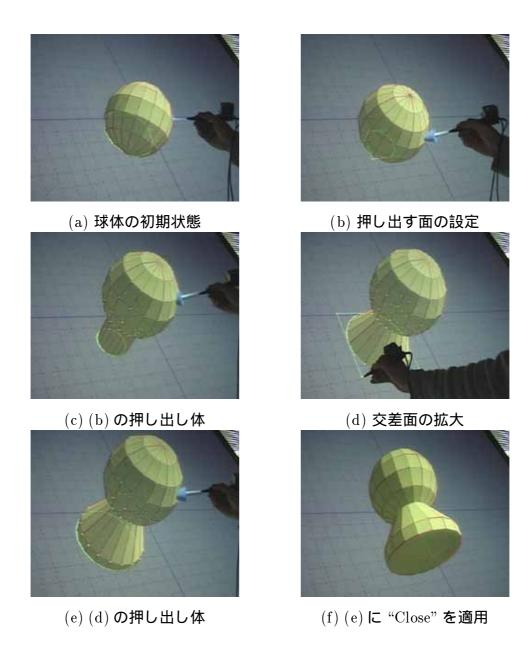
図 15 交差面の押し出しによる立体オブジェクトの変形
