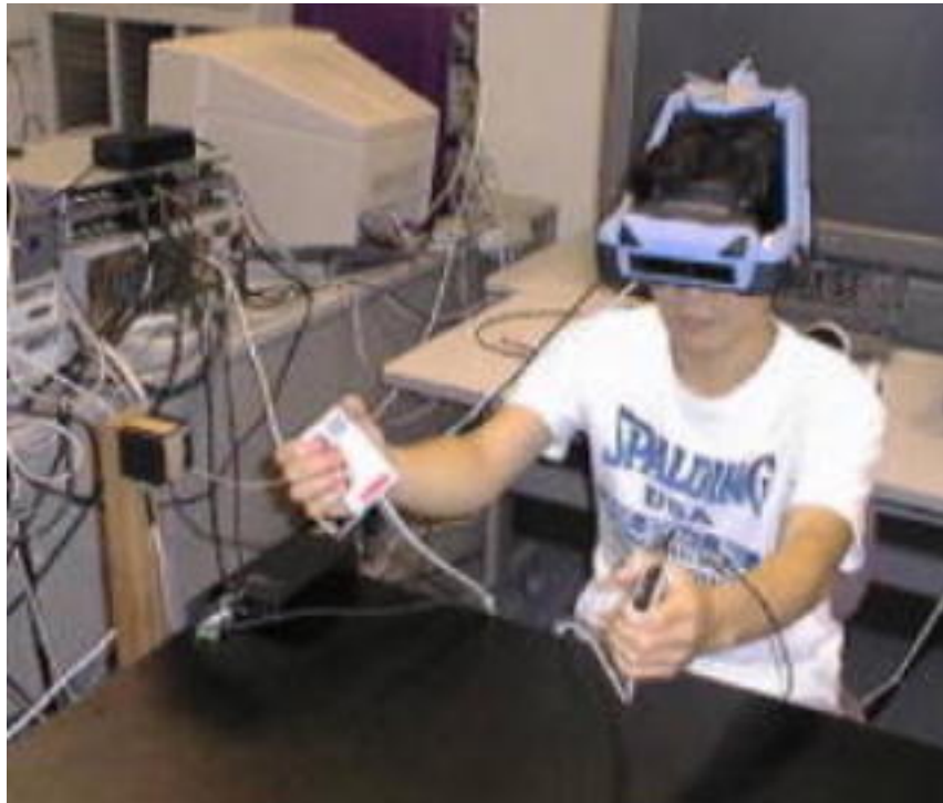
図 18 3次元位置入力装置と HMD を用いた作業風景
