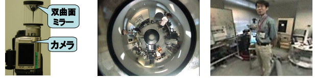
図 1: HyperOmni Vision の外観 図 2: 全方位画像 図 3: 平面透視投影画像
