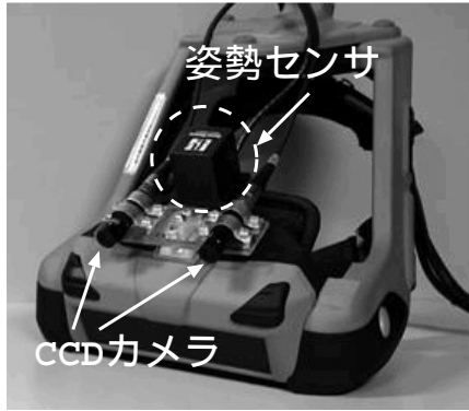
図1 姿勢センサとステレオカメラを組合わせたビデオスルー HMD Fig.1 Video see-through HMD with stereo cameras and an inertial sensor.
