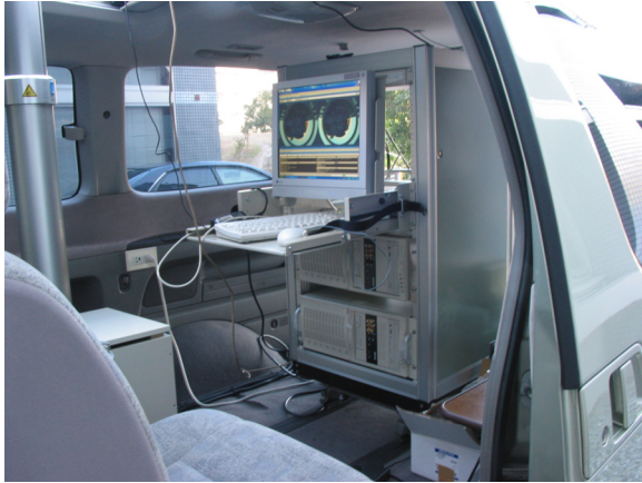
図 3：全方位画像取得車両搭載システム
