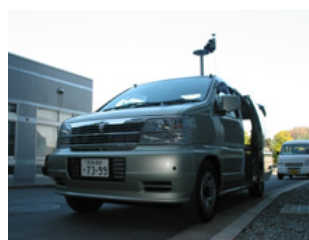
図2：全方位カメラ搭載車両 図3：Web ブラウザ画面
