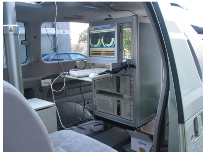
図 8 : 全方位画像取得車両搭載システム
