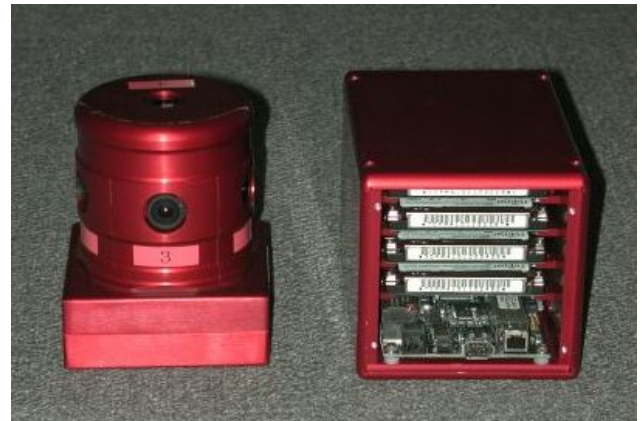
図2：全方位型マルチカメラシステム Ladybug
