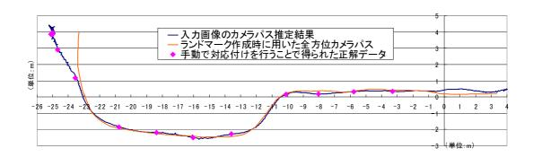
図 28 屋内実験において推定されたカメラパスと正解データ
