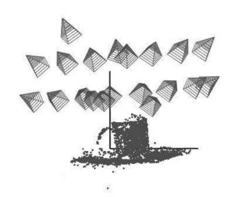
図 5 Gordon らの手法による環境内の特徴点の三次元復元結果 [26]
