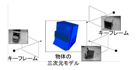
図 4 Lepetit らの手法で用いる三次元モデルとキーフレーム [25]
