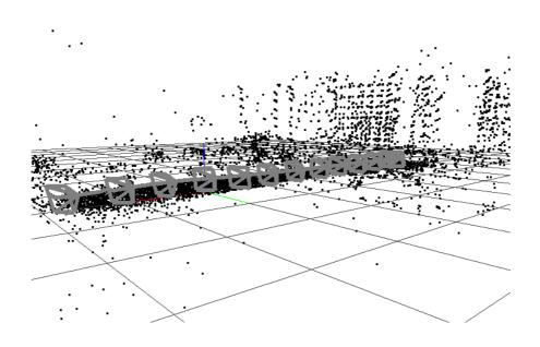
図 13 推定されたカメラパスと自然特徴点の三次元位置(屋外実験)
