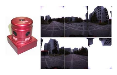
図 12 全方位型マルチカメラシステム Ladybug と撮影された全方位画像
