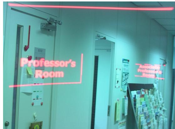
図 16 ウェアラブル型拡張現実感システムによる注釈提示
