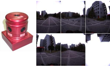
図 4: 全方位型マルチカメラシステム Ladybug と撮影された全方位画像
