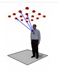
図 1 ActiveBat と天井に設置した超音波センサによる測位 [1, 2]
