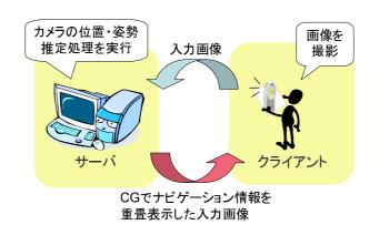
図 3 本研究で想定するサーバ・クライアント型システム
