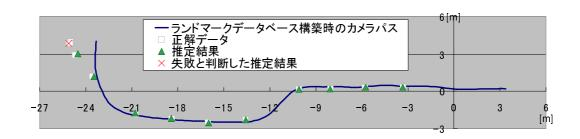
図 25 ランドマークデータベース構築時のカメラパスと入力画像の撮影位置の正解データおよび推定されたカメラ位置(屋内実験)
