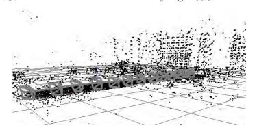
図 11 推定されたカメラパスとランドマークの三次元位置
