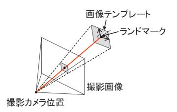
図 6 特徴ベクトルを抽出するためのランドマークの画像テンプレート
