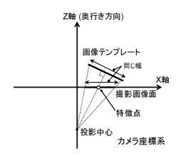
図 8 入力画像における画像傾き補正処理
