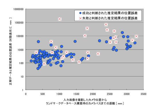
図 19 カメラ間距離とすべての推定結果の関係(屋外実験)
