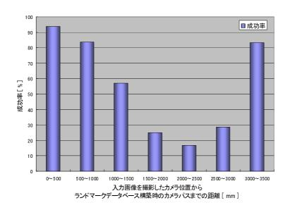
図 17 カメラ間距離と成功率の関係 (屋外実験)
