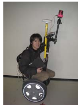
図 18: 全方位型マルチカメラシステムとGPS受信機
