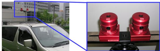
図 2 全方位カメラを搭載した撮影車両
