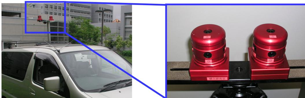
図 7 全方位カメラを搭載した撮影車両
