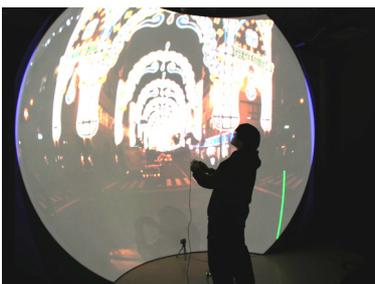
球面ディスプレイとゲームコントローラを用いたテレプレゼンスシステム。移動する自動車やジェットコースターに乗り、周囲の景色を見回す感覚を得ることができる。利用者はゲームコントローラを用いた見たい方向を自由に選択する。
