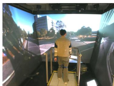
歩行装置とマルチプロジェクションディスプレイを用いたテレプレゼンスシステム。周囲を見回しながら静的な遠隔環境を自由に歩行移動する感覚を得ることができる。利用者の両足に取り付けられた、位置センサの情報を基に歩行装置のベルト及び映像が制御される。
